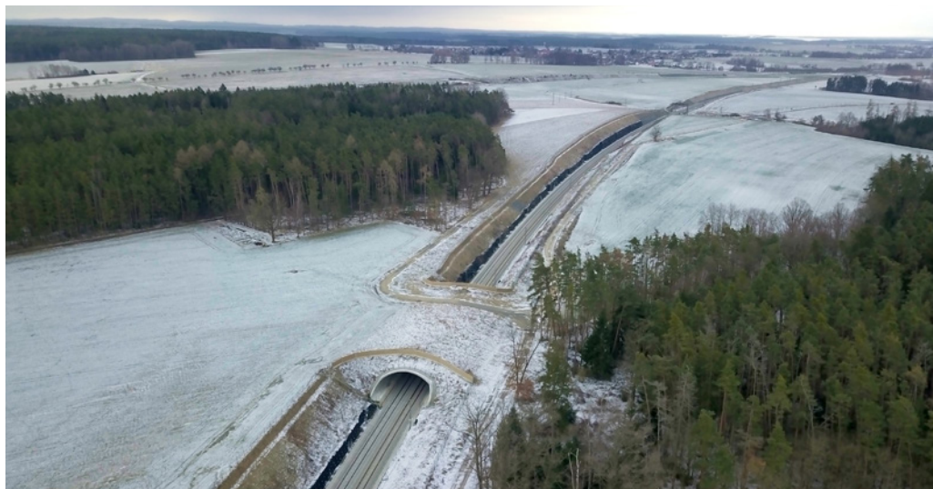
Obr. 7: První ekodukt na železnici u obce Doubí v jižních Čechách. Foto Martin Strnad
